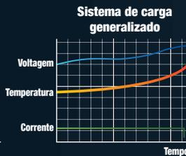
O sistema de carregamento rápido da Makita, comunica ao chip incorporado na bateria durante o processo de carregamento para otimizar a vida útil da bateria. Controlando ativamente a corrente, a voltagem e a temperatura.
